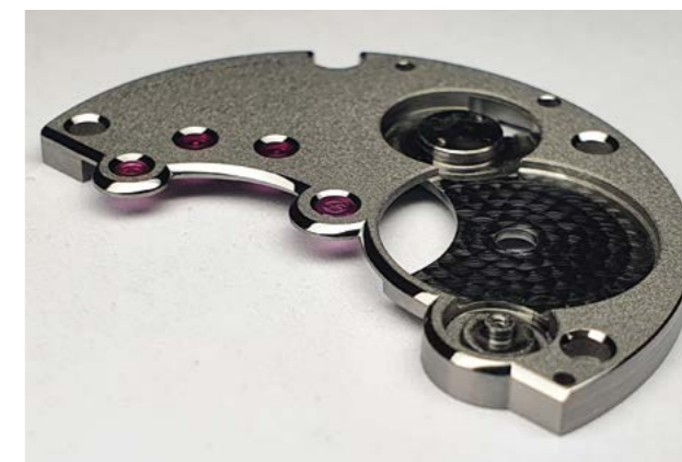
Un pont sablé et anglé main pour l'horloger Florent Lecomte, France
