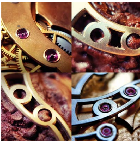
Un bel exemple de squelettisation manuelle, sur un mouvement de poche IWC
