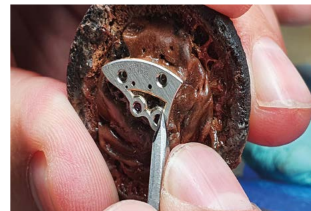
Un pont d'un Valjoux 234 squeletté main pour la marque Grenon & Cie, Canada
