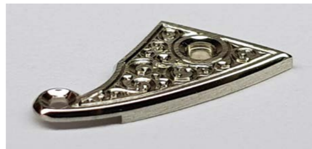
Exemple de pont en maillechort, gravé et anglé main
