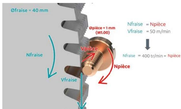
Figure 24: Principe du filetage par polygonage
