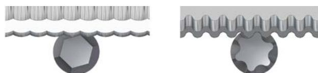
Figure 9: Fraisage par génération d'embouts de tournevis
