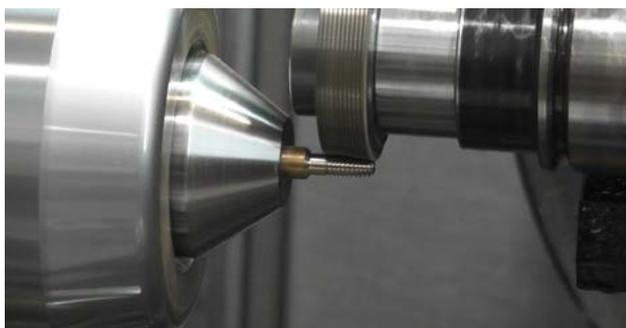
Figure 27 : Filetage par polygonage de forme
